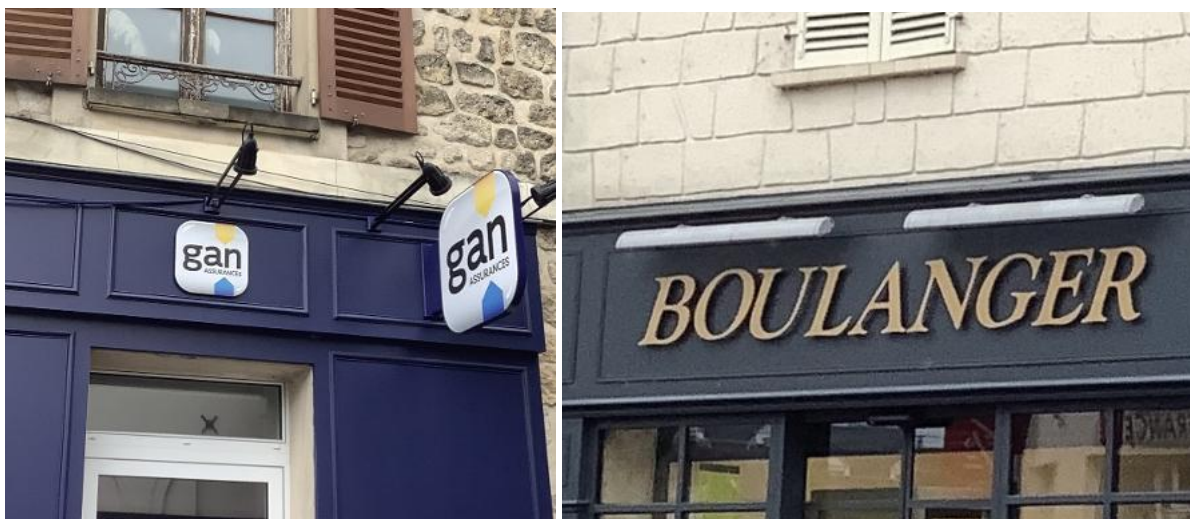
Enseignes éclairées par projection (par spot à gauche et par rampe d'éclairage à droite), Chambly, mai 2024
